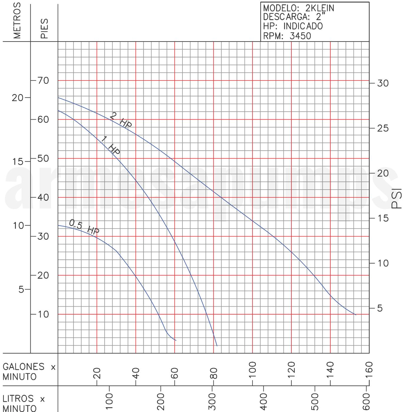
Prueba realizada con agua, gravedad específica 1.0 @ 20 °C (68 °F); otros líquidos pueden variar el rendimiento.
